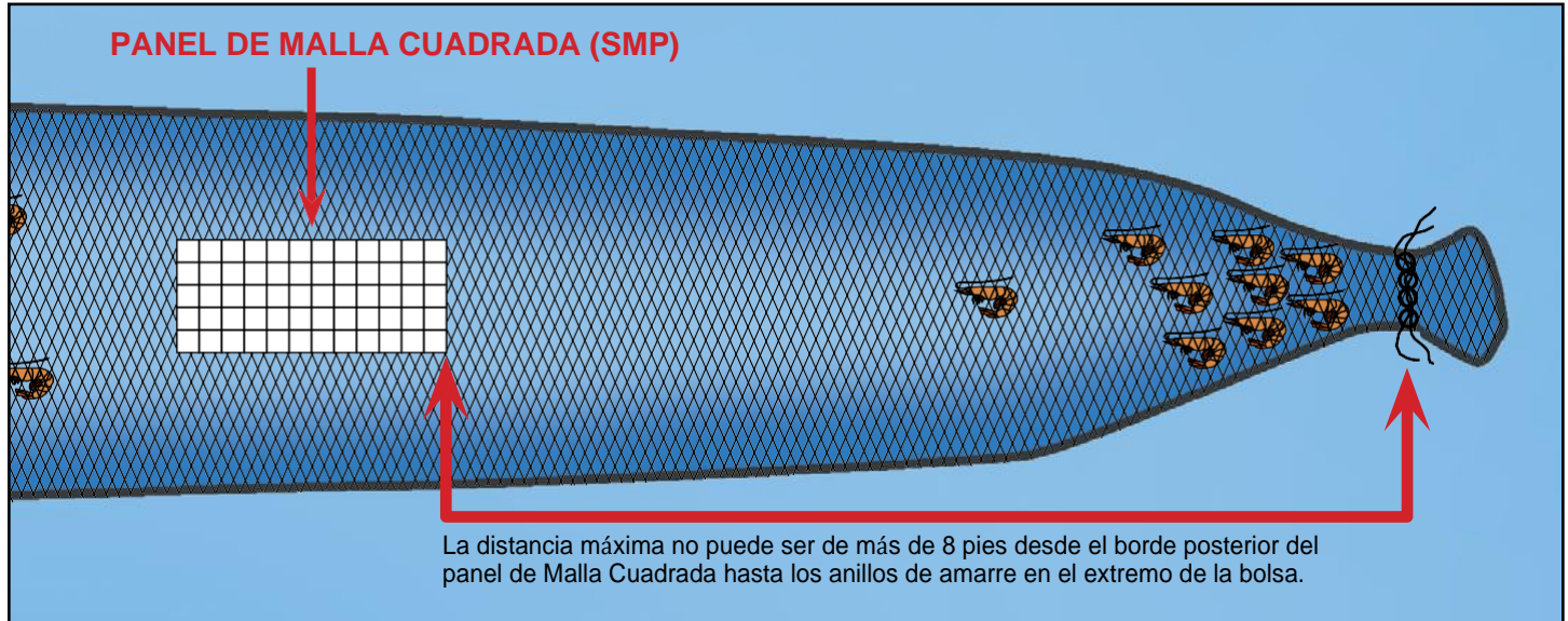
Figura H. El Panel de Malla Cuadrada está instalado en la parte superior de la red de arrastre a no más de ocho pies de los anillos de amarre.
