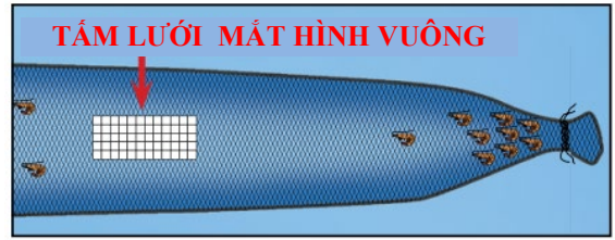
Hình D. Tấm lưới mắt hình vuông (SMP) khi nhìn từ phía trên.
